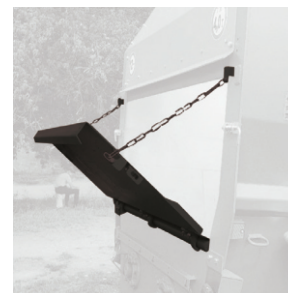
Открывающаяся крышка на задней стенке бункера
