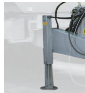
Гидравлическая опора дышла для удобства сцепки с трактором
