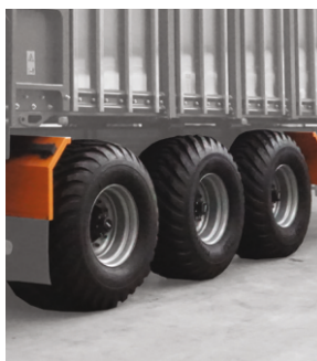
Подвеска типа «Тридем» с одной или двумя поворотными / самоподруливающими осями
