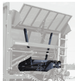
Система регулирования скорости движения передней стенки
