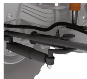
Гидравлическая блокировка поддуливающих осей для высокой проходимости
