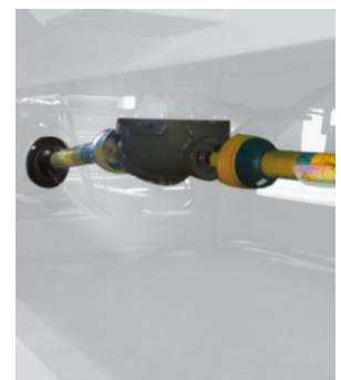
2 конических угловых редуктора с планетарным механизмом для снижения нагрузки на привод
