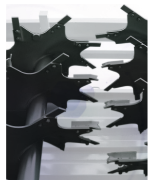
Два вертикальных битера большого диаметра для увеличения работоспособности и равномерности внесения удобрения
