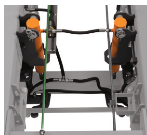
Стабилизация кузова при разгрузке для эффективности работы
