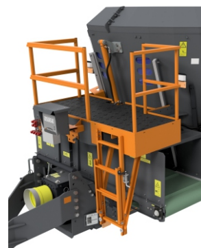
Многофункциональная площадка для удобства обслуживания
