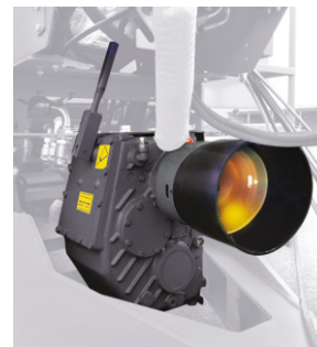
Редуктор снижает нагрузку на вал отбора мощности
