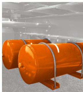
Двухконтурная пневматическая или гидравлическая (опция) тормозная система
