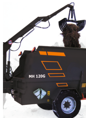
Угол поворота грейфера -240° без доворота машины
