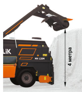
Высота подъема фрезы до 4 метров
